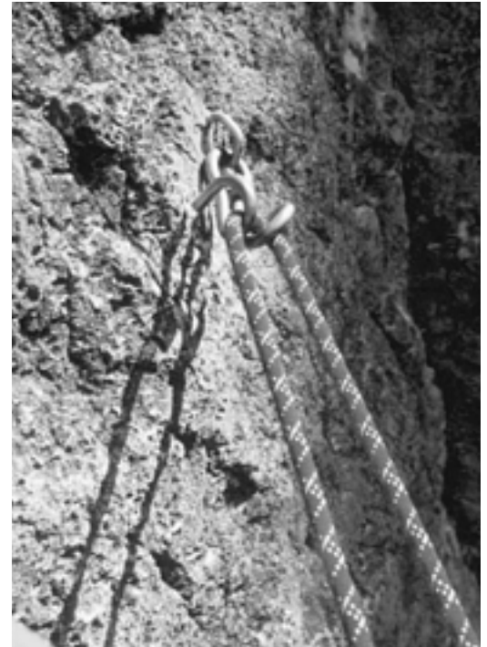
Abb. 4: Beim Abseilen im Klettergarten ein Seilende übersehen, 7 Meter-Absturz, Genickbruch. Deutlich zu sehen ist, dass durch den Abseilachter nur mehr ein Seilstrang läuft. Auch der perfekte Abseilpunkt, in diesem Fall ein geklebter Topropehaken, kann dieses Risiko nicht verhindern.
