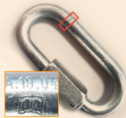
Riss in einem Peguet Maillon Rapide 8-mm der Seriennummer A.19.04
