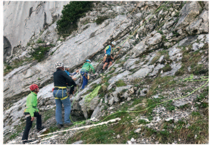
Abb. 4 Halteversuche kurzes Seil. Sowohl beim „Gehen am kurzen Seil“ als auch beim „gestaffelten Gehen“ zeigten die statischen Leinen aufgrund fehlender Dynamik, ihres glatten Mantels (geringere Reibung) und ihres dünnen Durchmessers (Handkraft) deutliche Nachteile gegenüber einem dynamischen Seil.
