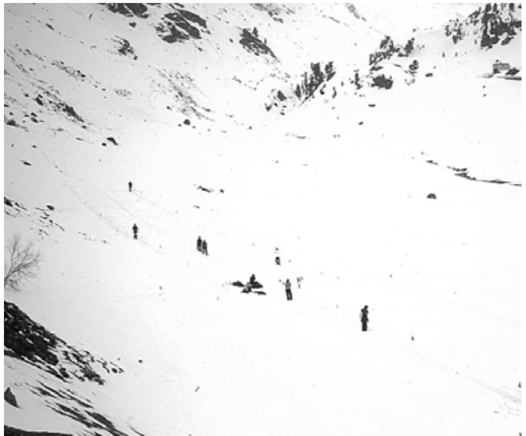
Bestimmung der mittleren Reichweite durch Vorbeigehen an einem beliebig orientierten Sender. Die Suchenden bewegen sich auf parallelen Suchlinien im Abstand von 5, 10, 15 und 20 m vom Sender.
