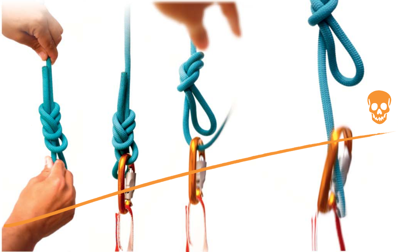
Abb. 2 Bei einem locker gelegten Achterauge kann sich unter Belastung ein zweites Auge bilden. Diese „neue“ Seilschleife führt immer zum Seilende und zieht sich zwingend auf, wenn der Karabiner versehentlich darin eingehängt wird!
