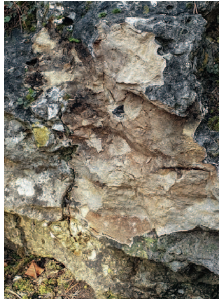
Abb. 5 a+b Ein Haken kann noch so hochwertig sein – in schlechtem Fels oder zu nahe an einer Kante gesetzt, kann er mitsamt dem Fels ausbrechen, wie dieses Exemplar in der Untersuchung.
