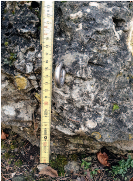
Abb. 5 a+b Ein Haken kann noch so hochwertig sein – in schlechtem Fels oder zu nahe an einer Kante gesetzt, kann er mitsamt dem Fels ausbrechen, wie dieses Exemplar in der Untersuchung.
