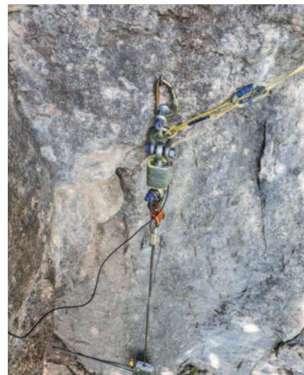
Abb. 1 Mit diesem Aufbau wurden Haken in axialer Richtung (Verlängerung des Schaftes, senkrecht zum Fels) getestet.
