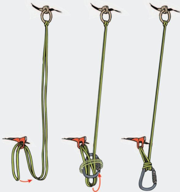
**Abb. 4 Mit vernähter Schlinge an zwei Fixpunkten direkt gefädelt und sechs Strängen im Ankerstich am Zentralpunkt.**
