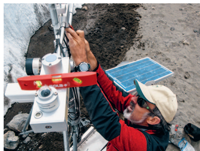
Georg Kaser bei der Installation von Strahlungsmessgeräten an der Eiswand des Northern Ice Field, Kibo, Kilimandscharo. Fotos: Archiv Kaser
