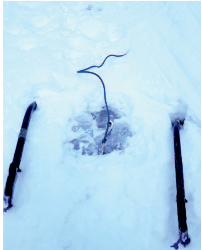
Abb. 3 Der Standplatz am Obstanser-Eisfall nach dem Absturz (bzw. beim Lokalausgesehen der Alpinpolizei). Links der Platz bzw. die Eisqualität der ausgebrochenen Eisschraube, daneben die verbliebene zweite (rechte) Eisschraube mit den Resten der Reepschnur (im hohlen PA-Mantel befand sich nur ein kurzes Stück Aramid-Kern). Quelle: Unfallprotokoll von Alpinpolizist Klaus Hanser.
