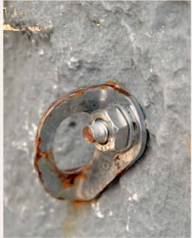
Abb. 2 Lasche mit einer radialen Bruchfestigkeit von 17,7 kN statt der geforderten 25 kN (unten). Lasche desselben Herstellers zwei Tage nach Setzen in der Halong-Bucht/Vietnam (rechts).
