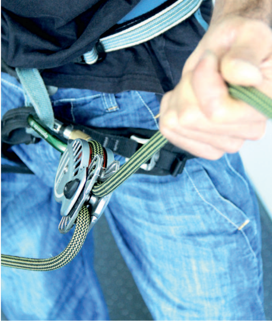
Abb. 9 Revo. Der schwarze Hebel öffnet das Gerät, das sich zum Einlegen des Seiles auseinanderschieben lässt. Das Gerät ist symmetrisch gebaut, d.h. es ist egal, wie es eingehängt wird und wo das Seil ein- bzw. ausläuft. Da es 1:1 wie ein Tuber bedient wird, muss das Bremsseil nur vom Körper weg herauslaufen. An beiden Seiten befinden sich Nasen mit Bremsschlitzten.
