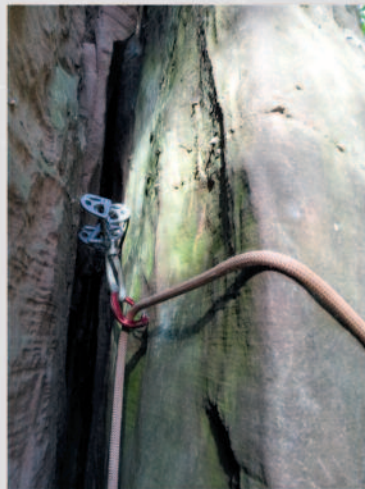
Abb. 10 Seilriss (links) knapp über Zwischensicherung an runder Sandsteinkante (rechts) durch eine Kombination von Schnitt- und Scherbelastung. Foto: Chris Semmel, Daniel Gebel
