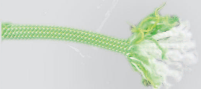
Abb. 11 Beim Ablassen von zwei Personen am Einzelstrang riss das 8,7-mm-Einfachseil an einer runden Granitkante. Foto: Chris Semmel
