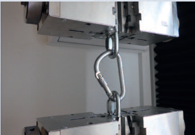
Abb. 3 Das Ergebnis: Alle drei Karabiner brachen erst jenseits der angegebenen Bruchkräfte.
